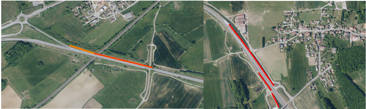
Emplacements des écrans acoustiques à Argiésans (à gauche) et Botans (à droite)
